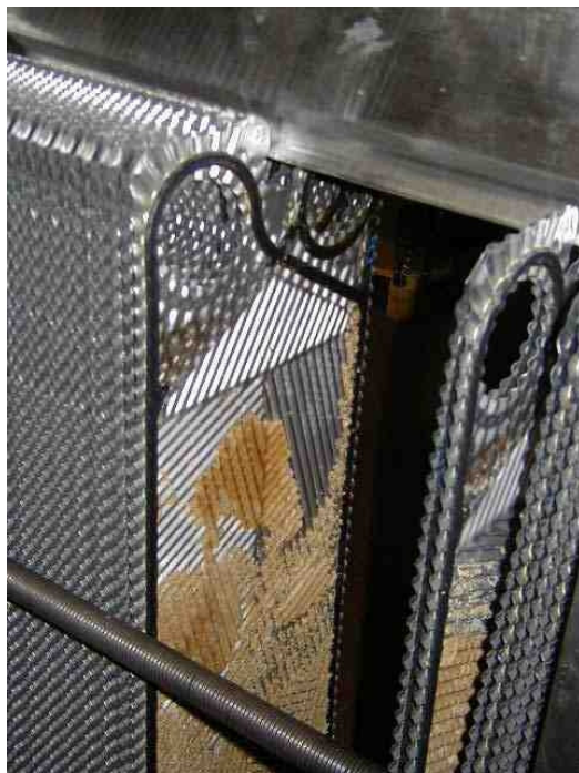
شکل ۹-۲- نمونه رسوب گرفتگی در یک مبدل صفحه ای
